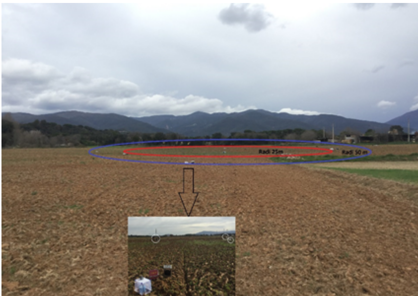
Campanya de camp de sísmica passiva per a la implementació de mesures de soroll sísmic en Array a la zona del Vallès dins el projecte Geourban
