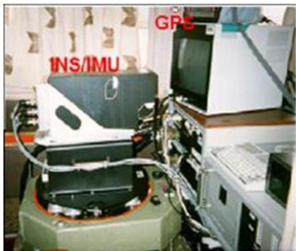
Integració del sensor CASI amb un receptor GPS i un INS
