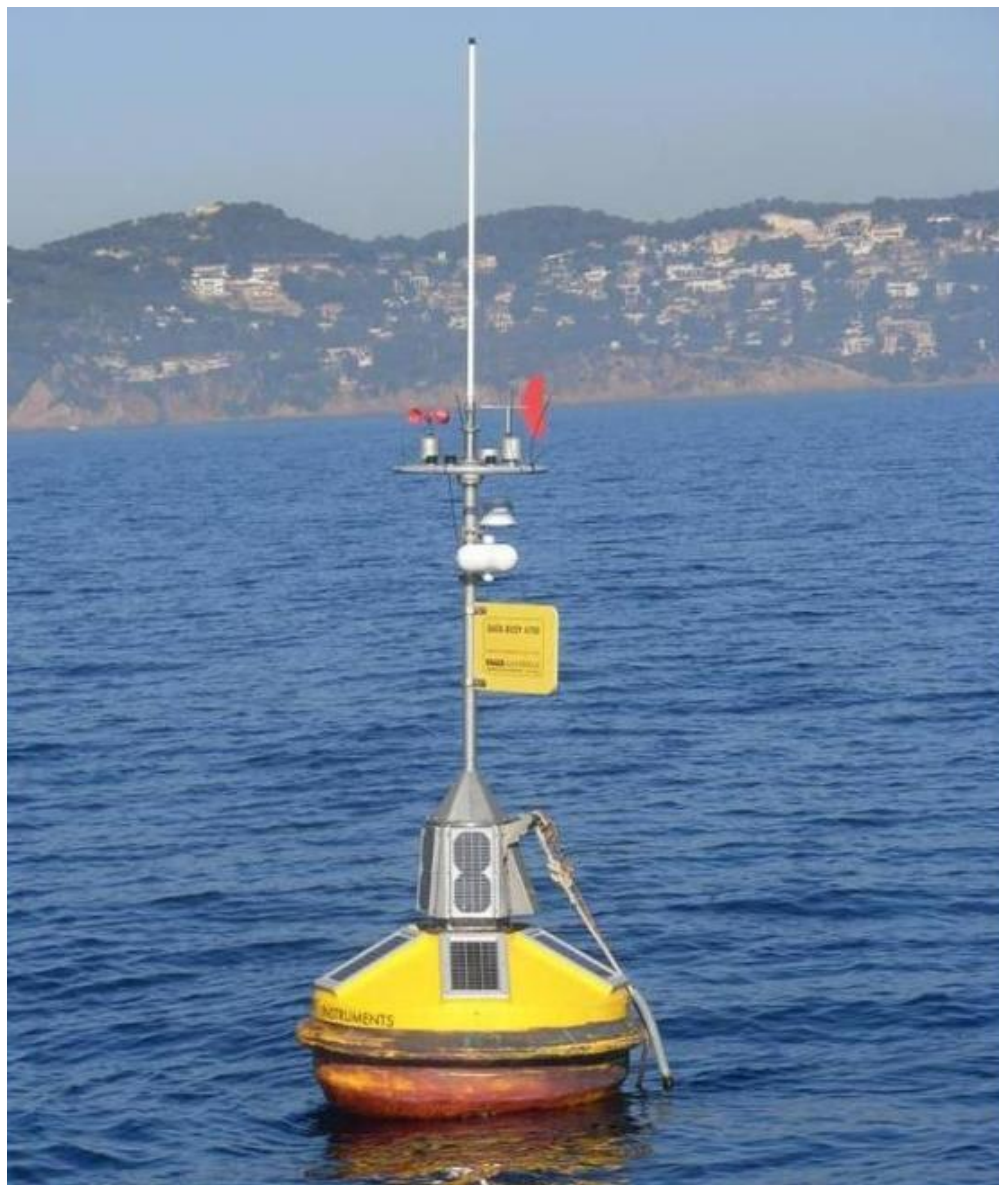
Figura 2: Tipologia de les boies meteoceanogràfiques situades actualment a la costa catalana
