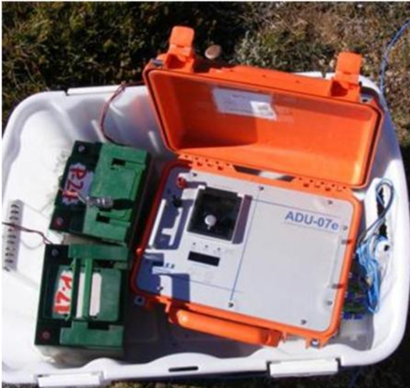
Instrumentació geofísica utilitzada en el mètode magnetotel·lúric
