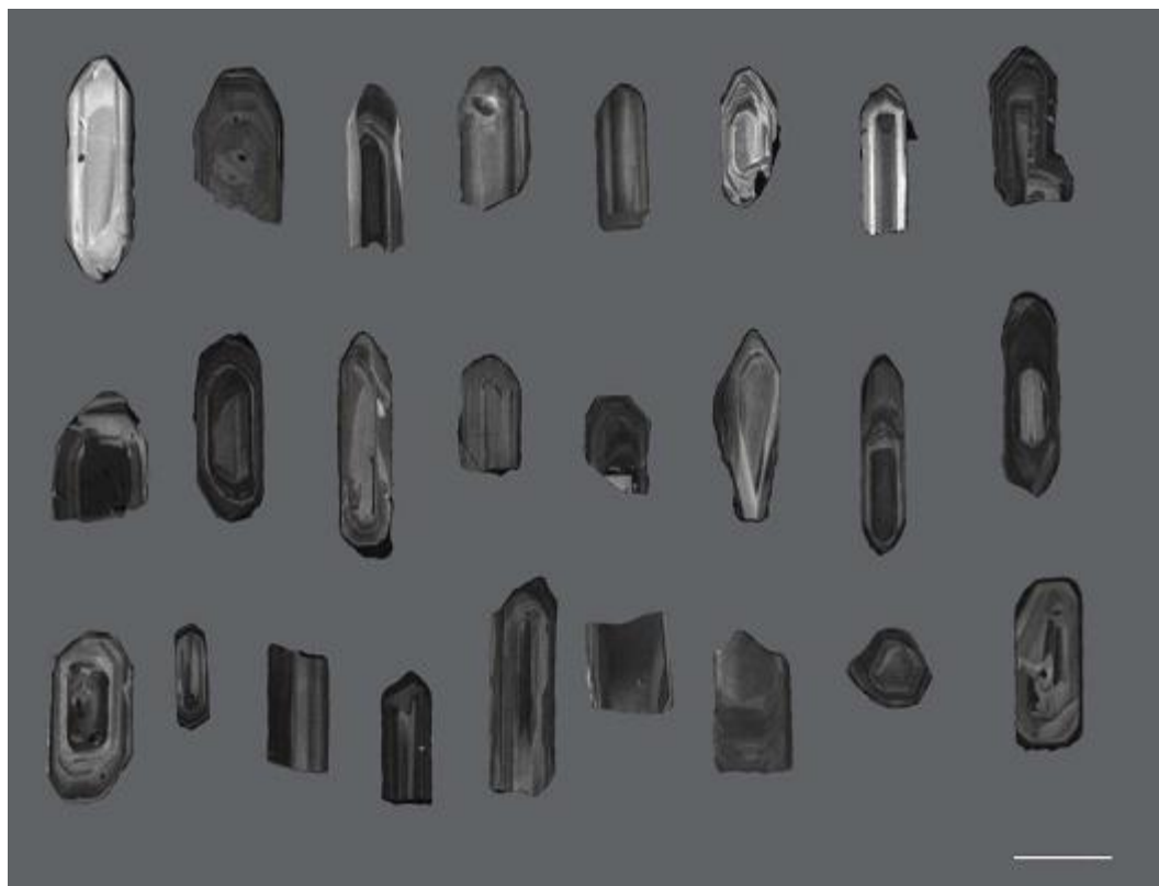
Zircons muntats en una proveta per ser datats pel mètode U-Pb SrrimpRG
