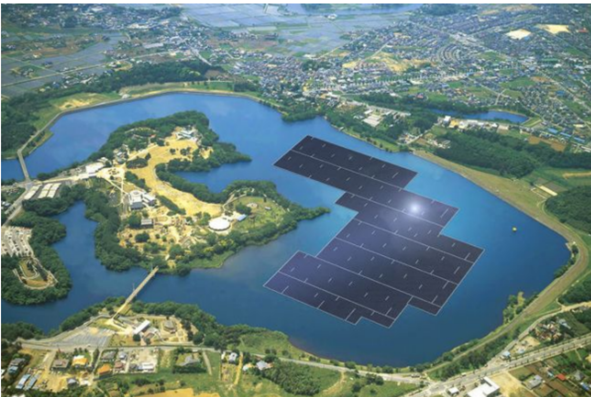
Recreació de l'aspecte final que podria oferir la central flotant de Chiba (© Kyocera Corporation)
