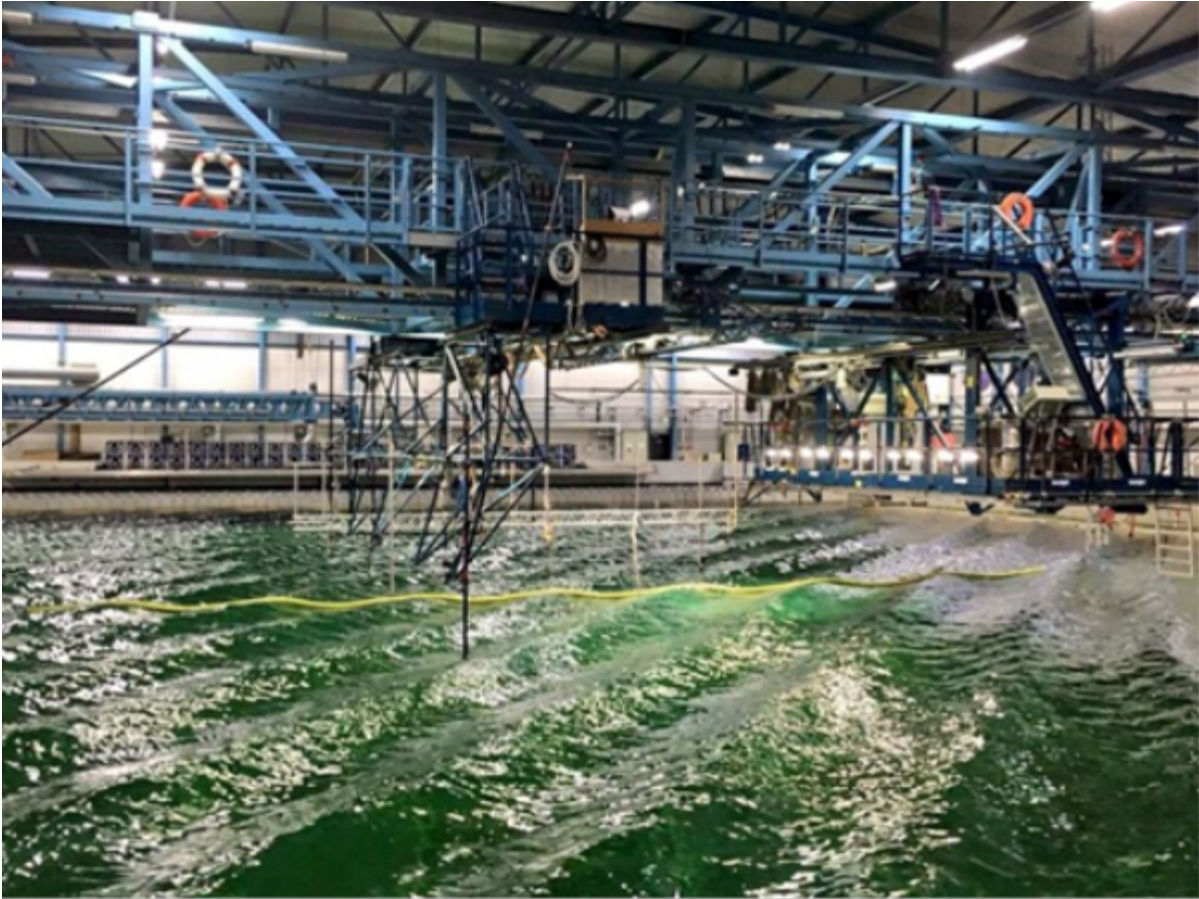
Proves del sistema en una piscina d'onades artificials (© Boyan Slat)
