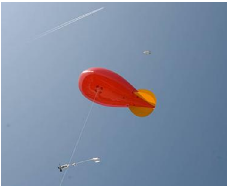
Globus captiu mesurant compostos orgànics volàtils de l'aire. Foto: CREA
