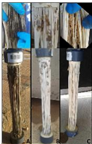
Imatges de les membranes a escala pilot: abans de netejar-les (dreta), mig, després de netejar-la amb NaClO i l'esquerra netejada amb ClO2.
