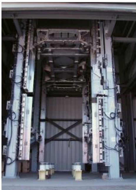
El sistema de guies i una prova en horitzontal del sistema LSM. (© Elevator World)
