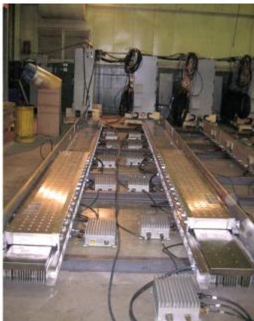
El sistema de guies i una prova en horitzontal del sistema LSM. (© Elevator World)
