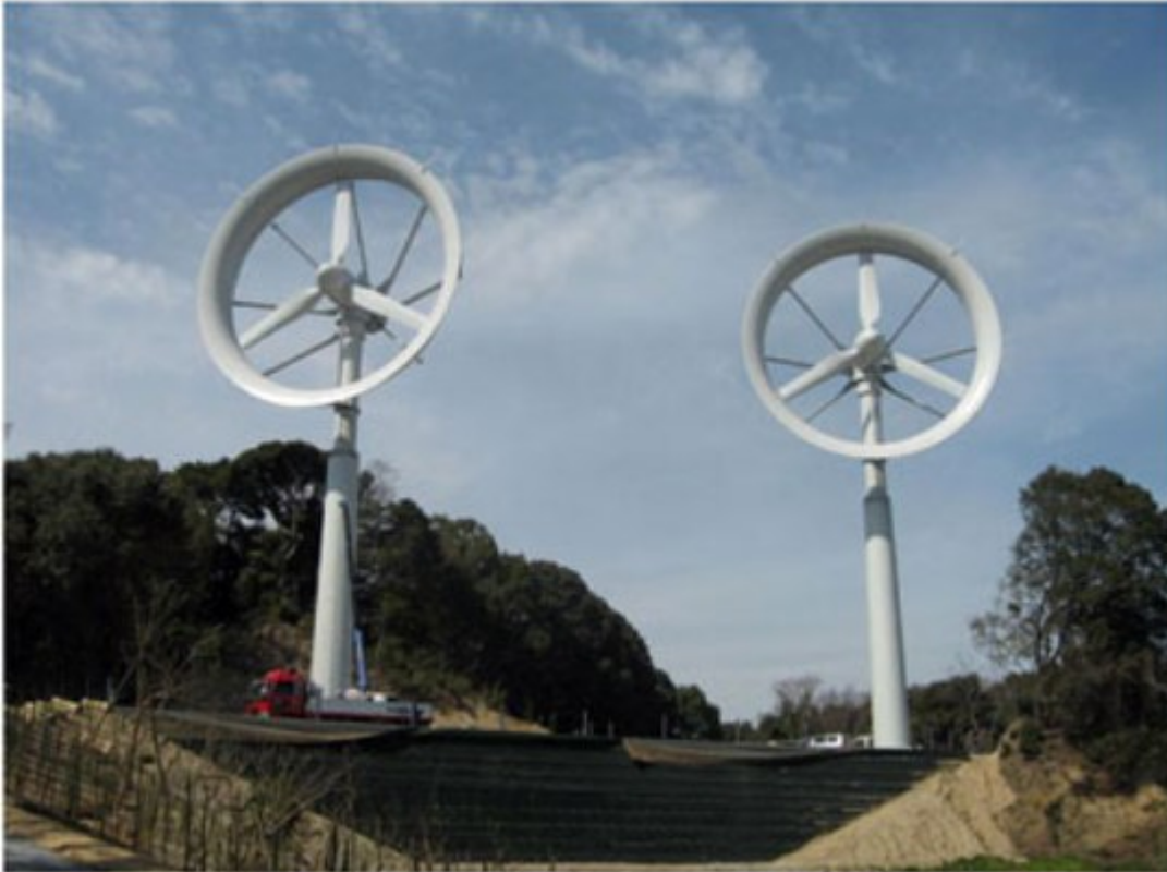
Prototip de Wind Lens al campus de la Universitat de Kyushu. (© RIAM Kyushu University)
