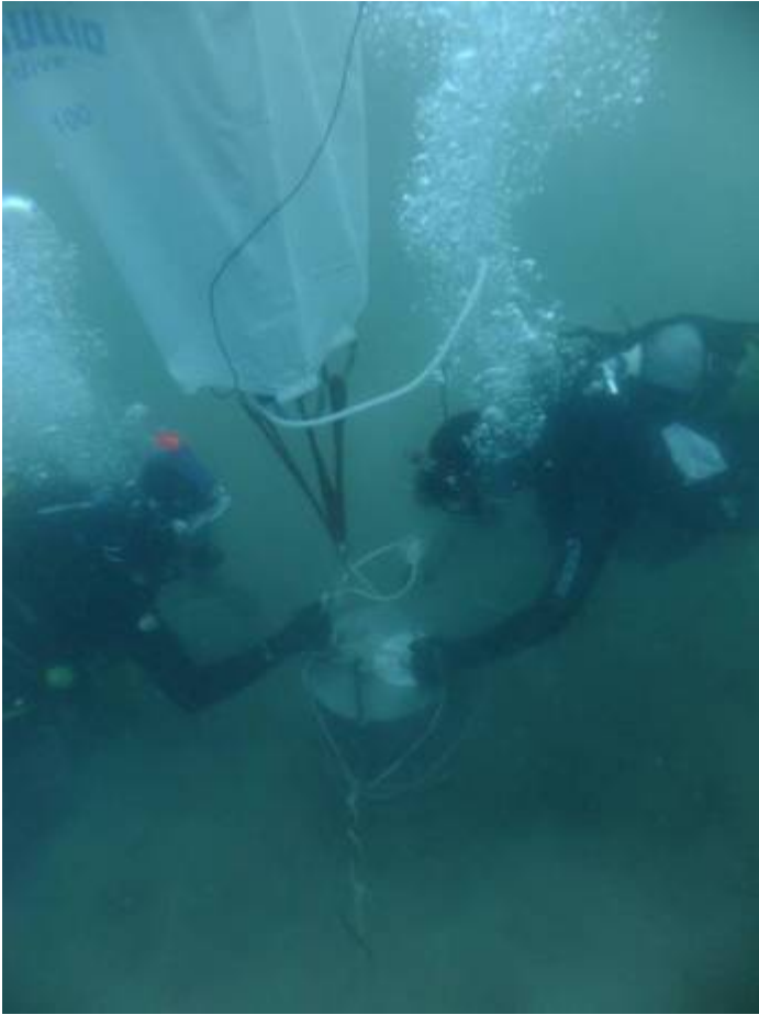
Instal·lació OBS cablejat
