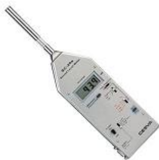
Sonòmetre SC20e (que va incorporat a l'estació SIAC i proporciona dades al servidor central)
