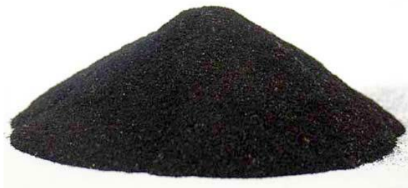
Fotografia 3: cautxú pretractat procedent de la trituració d'NFVU TyreXol™.
