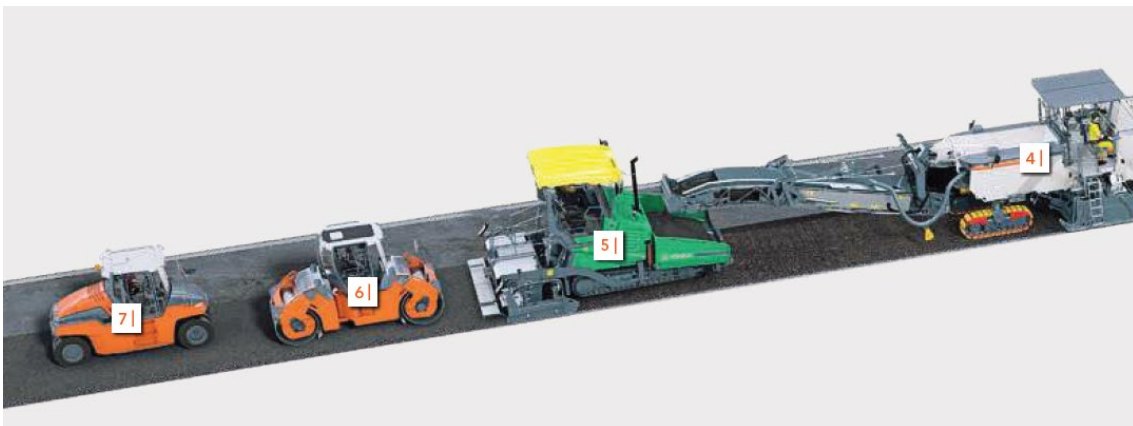
Imatge 4. Detall operació de transferència de la mescla reciclada
