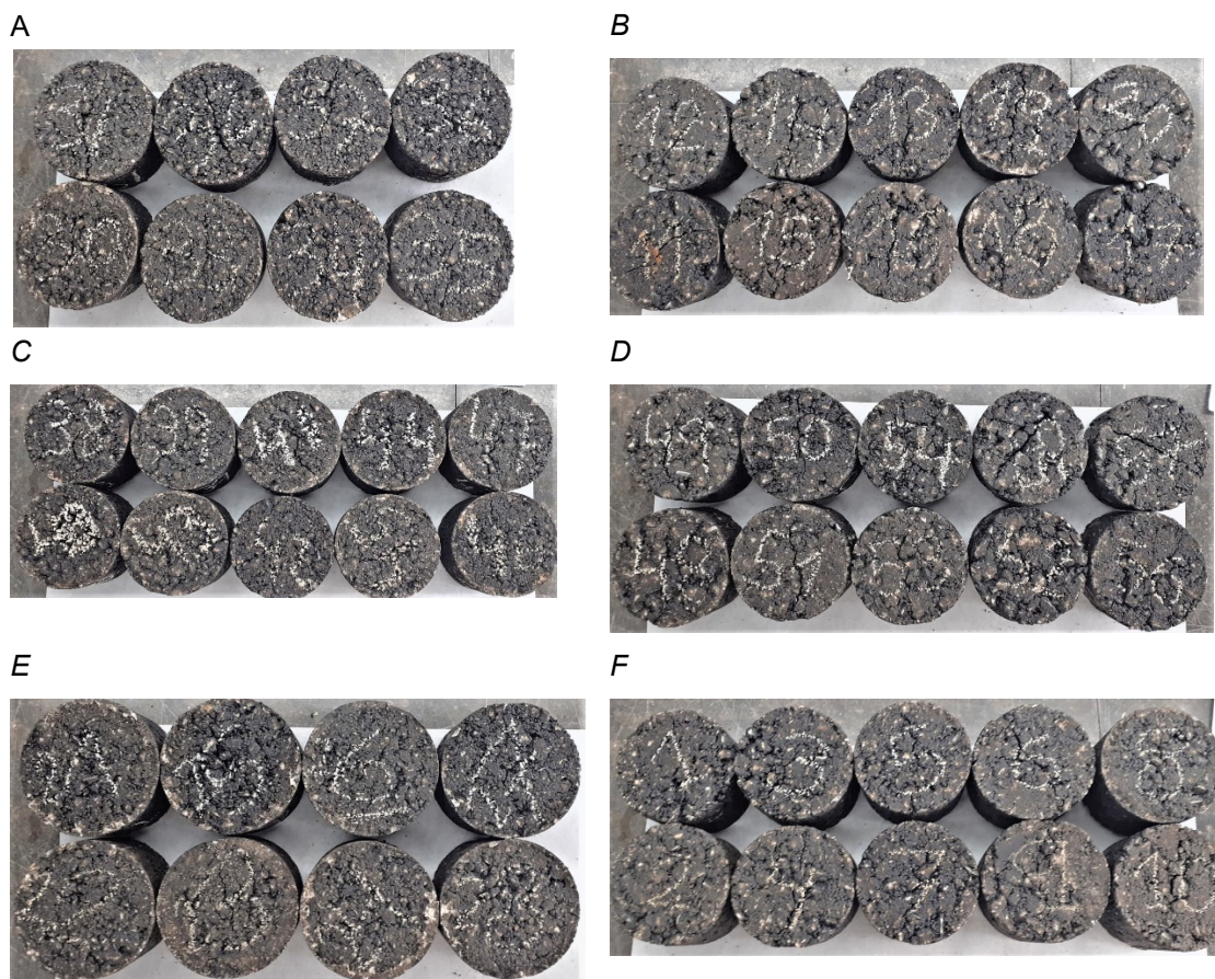
Figura 9: Provetes ja trencades de l'anàlisi de sensibilitat a l'aigua. A, C i E: mescla AC 11 SURF PMB 45/80-65 S VIDRE; B, D i F: mescla AC 16 SURF 35/50 S; A i B: sèrie 1; C i D: sèrie 2; E i F: sèrie 3
