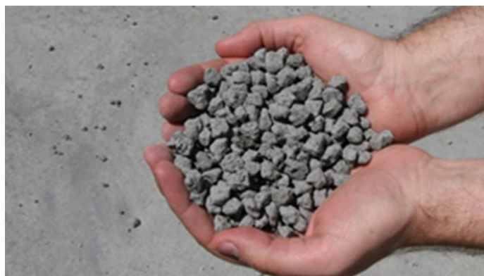
Figura 3. Detall de l'àrid siderúrgic per a la mescla bituminosa
