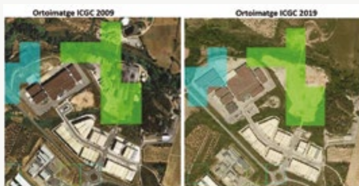
Canvis detectats per aprenentatge profund a partir d'ortoimatges de diferents anys. Font: Institut Cartogràfic i Geològic de Catalunya.
