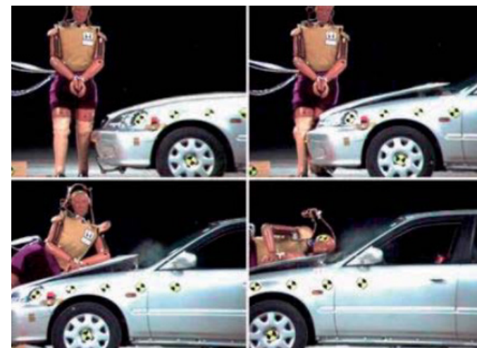
Disseny innovador del vehicle: airbag del capó. Font: EuroNCap.
