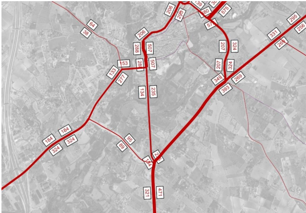
Figura 30. Trànsits a Valls modelitzat amb Visum amb les dades del graf de mobilitat de Catalunya de 2012.
