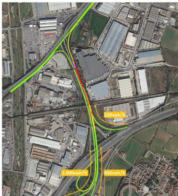
Figura 3. Intensitats en hora punta del ramal al 2016, considerant les connexions de l'AP-7 sentit Nord i Sud i la C-33 sentit Nord
