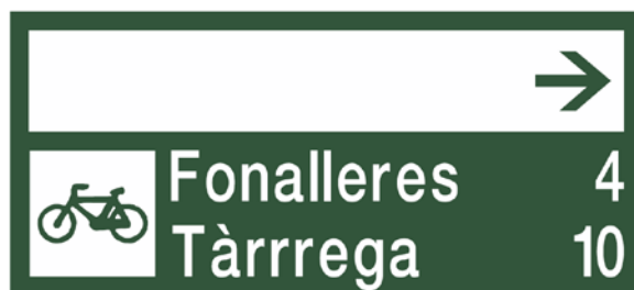
Figura 7.8 Plafó de direcció final en tram preferent per indicar una variant o antena sense pictograma específic
