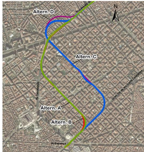
Figura 62. Traçat de les diferents alternatives considerades pel perllongament de la línia Llobregat – Anoia
