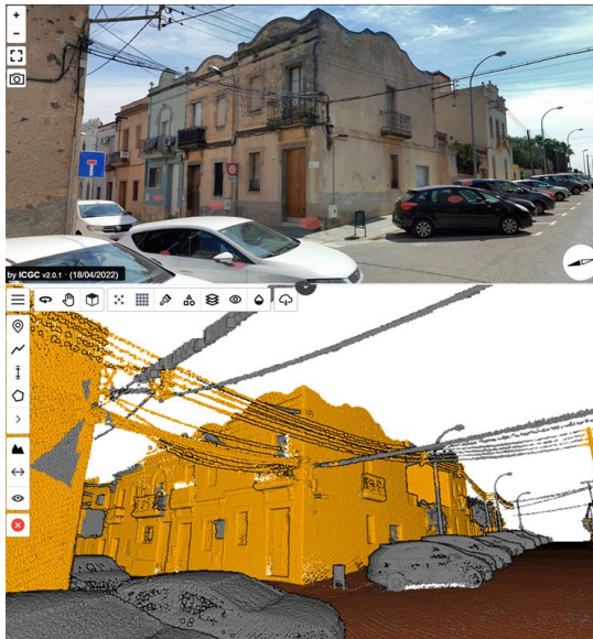
Captura de dades amb informació del mobiliari urbà, cablejat, entre d'altres elements. S'ha utilitzat la tecnologia Mobile Mapping, que combina fotografies panoràmiques del territori amb dades LIDAR i proveeix geoinformació digital dels nostres municipis amb una aparença quasi real i un alt nivell de precisió. (Font: ICGC).
