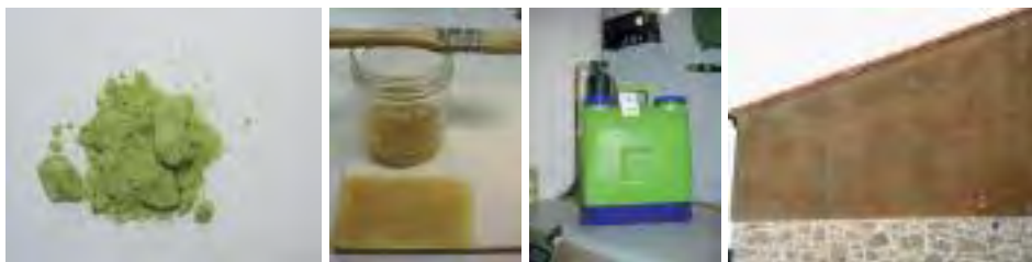
Ensulfatar sobre un arrebossat de calç dona lloc a una pàtina de color rogenc que en les paisatges agraris s'integra molt bé.
