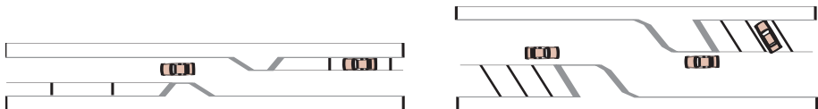
Figura 6.10. Diverses possibilitats de combinació de places d'aparcament amb desplaçament de l'eix de la trajectòria
