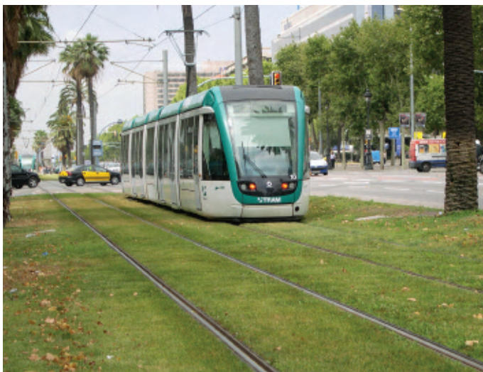
Figura 5.29. Exemple de tramvia amb plataforma segregada de la calçada per a circulació de vehicles
