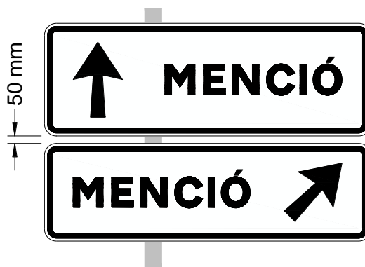
Figura 17. Separació dels plafons
